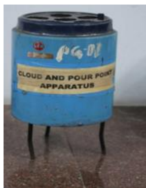
Fig. 10. Cloud and pour point measuring apparatus.
